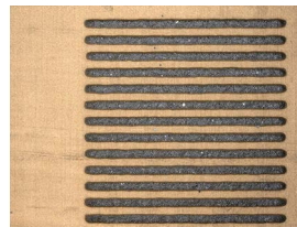
Druck nach 1 Stunde Wartezeit (180 µm)
