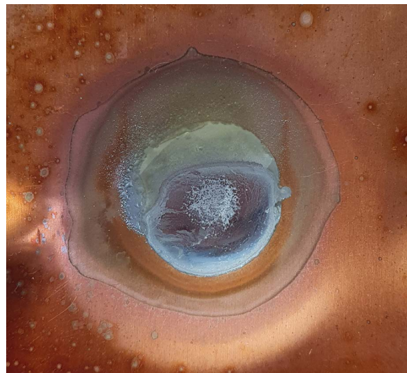
Keine Korrosion: Klassifizierung L
